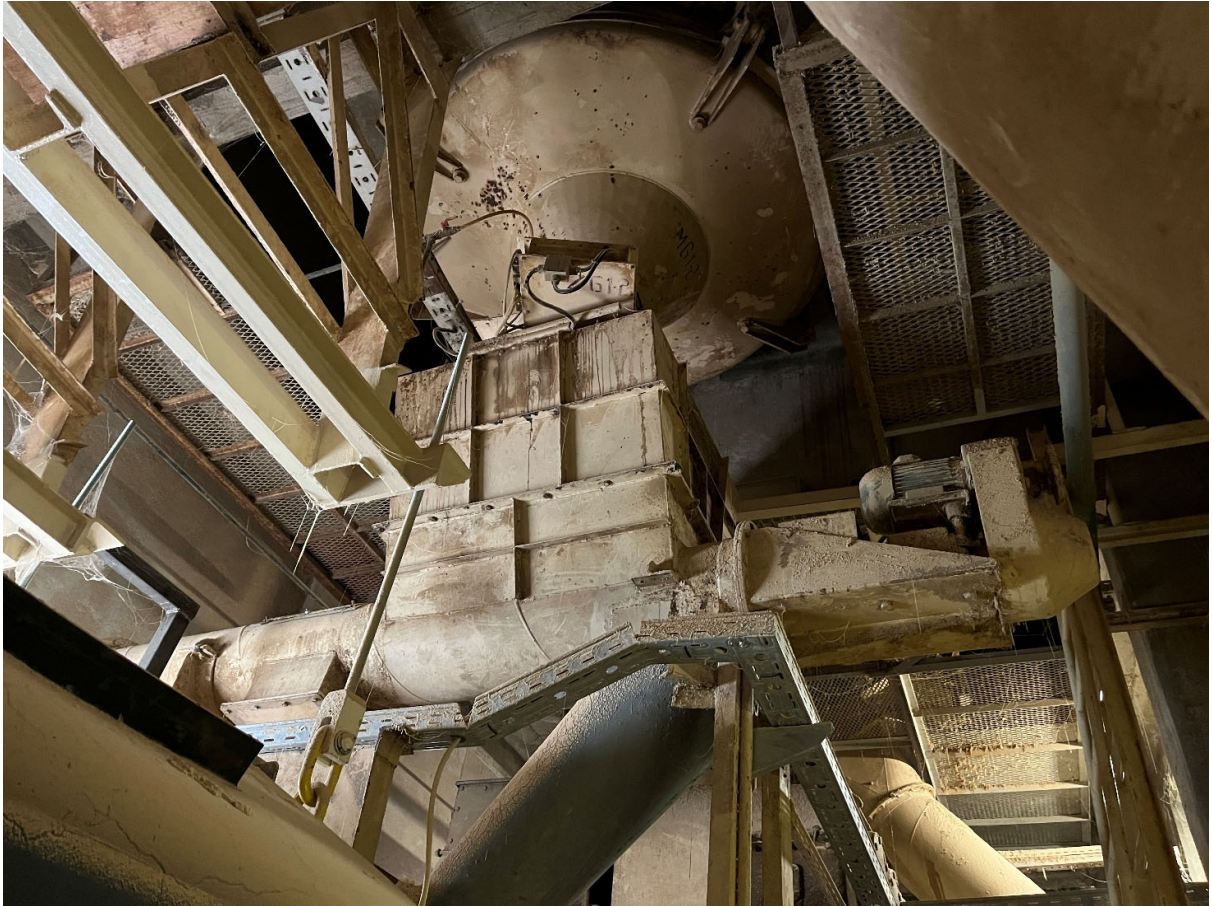
SLIKA 4: IZVZEMNO MESTO IZ BUNKERJA PRAHU ŠT. 57
